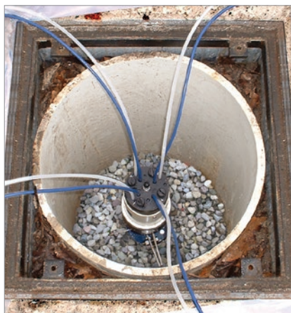
Uso de registros núcleo para identificar ubicación de puertos y sellos mecánicos (izquierda). El manifold de purgas múltiples con transductores y bombas dedicadas para cuatro monitorizaciones de zona (derecha).
