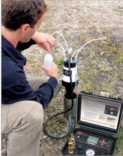
Recolección de una muestra desde un DVP dedicado y toma de mediciones de presión con el modelo 404 de lectura de cuerda vibrante Geokon.
