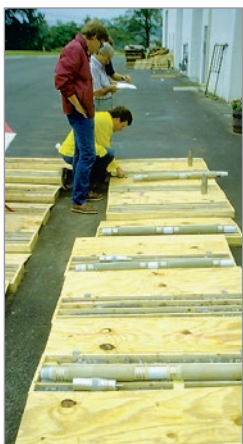
Uso de registros núcleo para identificar ubicación de puertos y sellos mecánicos (izquierda). El manifold de purgas múltiples con transductores y bombas dedicadas para cuatro monitorizaciones de zona (derecha).
