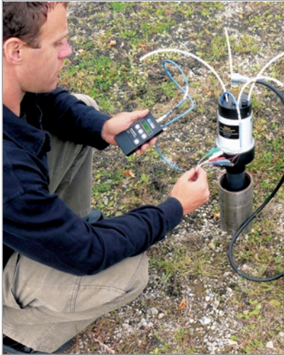
Recolección de una muestra desde un DVP dedicado y toma de mediciones de presión con el modelo 404 de lectura de cuerda vibrante Geokon.
