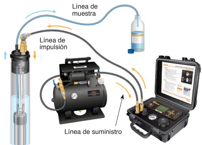
Configuración de bombeo con la unidad de control electrónica de la bomba Modelo 464 a 125 psi, con compresor de 12 voltios
