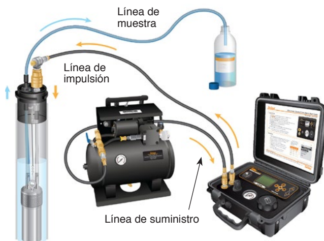
Configuración de bombeo con la unidad de control electrónica de la bomba Modelo 464 a 125 psi, con compresor de 12 voltios
