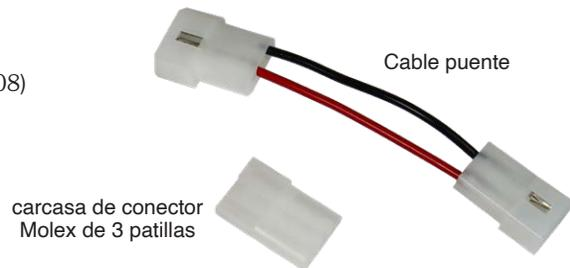
**Nota:** El cable de puente sólo es necesario si está conectando la nueva cinta láser a un medidor de nivel de agua Mk1 modelo 101 que anteriormente utilizaba cinta de polietileno (con marcas rojas ft/m). El Conector Molex de la electrónica de la placa frontal tendrá una conexión de 2 pines.
