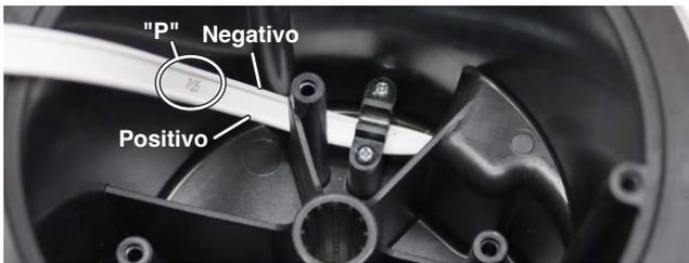
9. Para modelos con las guías que se insertan en la tarjeta de circuitos, corte los pines que están en las guías de la cinta tal y como se aprecia en la foto abajo. Utilice alicates para aplanar las guías de tal manera que se puedan colocar en los terminales de a tarjeta (ver paso 12).
