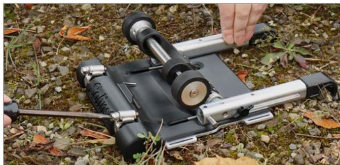
2. Tenga en cuenta los posibles puntos de pellizco del movimiento del brazo oscilante. Utilice el "talón" de la mano para empujar firmemente hacia abajo el eje impulsor del rodillo hasta que llegue a la placa base. Empuje el pasador de bloqueo en el orificio del brazo oscilante. Esto mantendrá el brazo oscilante cargado por resorte en su lugar. Asegúrese de que el pasador esté completamente insertado. Esto mantendrá los rodillos apartados mientras se instalan en un carrete SC1000 (pequeño).
