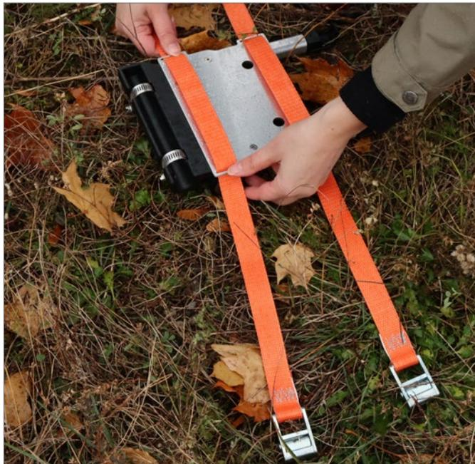
1. Para conectar las correas de cincha, páselas a través de la base de la Power Winder como se muestra en la foto de arriba.
