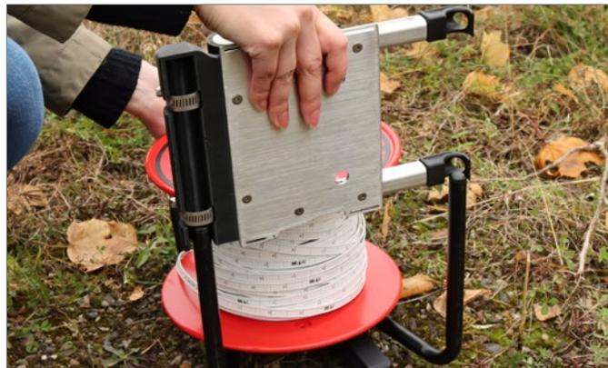
5. Con el carrete todavía de lado, apriete las abrazaderas del engranaje para asegurar la Power Winder al carrete. Esto asegura que la Power Winder esté apretada contra el extremo de la pata y que los rodillos estén alineados con el carrete.
