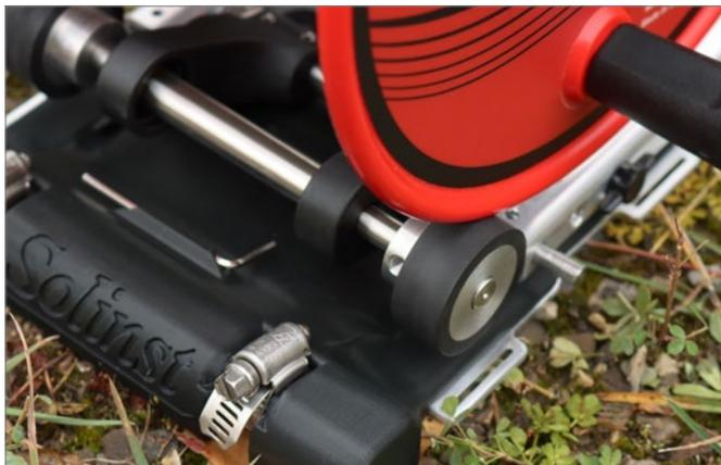
**Notas:** La llave Allen de 3/32 "suministrada con la Power Winder se puede utilizar para aflojar los dos rodillos de modo que pueda ajustarlos para que quepan en cubos de carrete de diferentes anchos. Deslícelos en las posiciones correctas y luego apriételos en su lugar.
