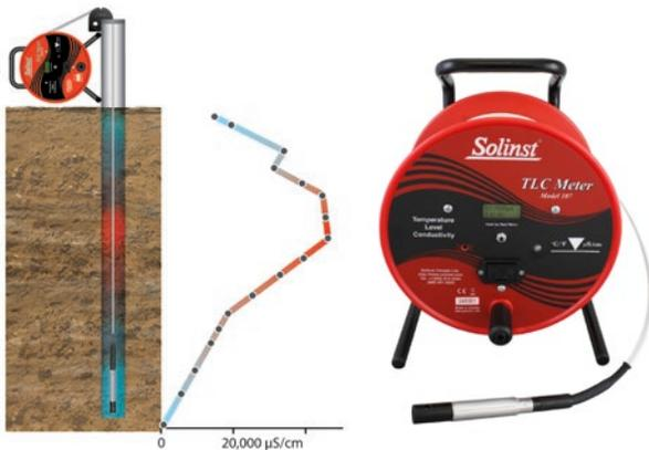
La sonda está conectada a una cinta plana de alta calidad para tomar mediciones de nivel el cual se indica con una luz y un pitido. La cinta esta exactamente marcada con láser cada milímetro o cada 1/100ft, en longitudes hasta de 300m o 1000ft. La sonda y la cinta están instaladas en un carrete resistente para facilitar su operación. Las lecturas de Conductividad y Temperatura se ven la pantalla LCD.
