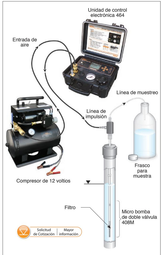
Configuración típica de muestreo de la 408M
