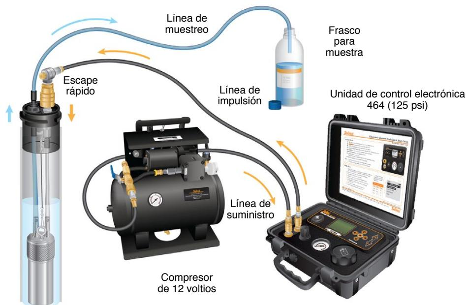
Figura 3-1 Configuración de bombeo
