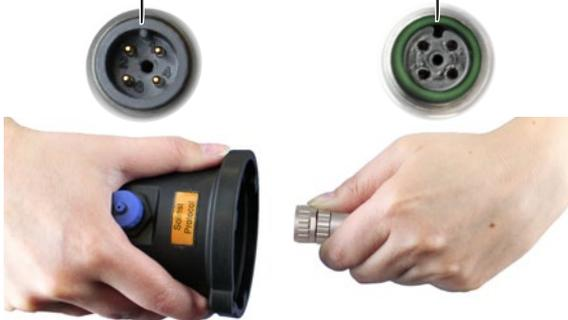
Alinee el enchufe de alineación en el conector del cable veteado con la clavija de alineación del conector del cabezal de pozo.
