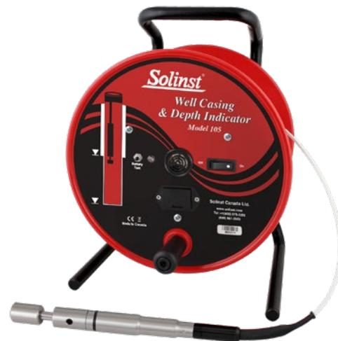
Le 105 Well Casing & Depth Indicator est utilisé pour détecter les tubages métalliques des puits et mesurer la profondeur totale du puits. Il offre ces deux fonctions à l'aide d'une seule sonde.
