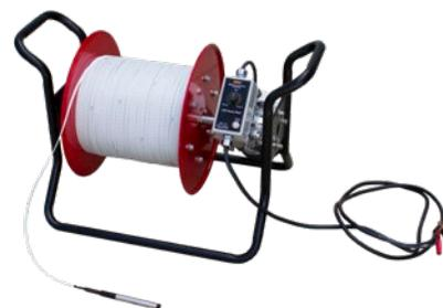
Le 101 Power Winder est disponible pour être fixé à n'importe quel modèle ou taille de bobine Solinst, afin de permettre un enroulement sans effort de plus grandes longueurs de ruban. Il fonctionne avec une perceuse électrique standard.
