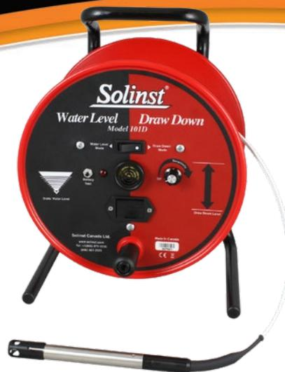
Le modèle 101D du compteur de niveau d'eau DrawDown Meter partage les mêmes qualités que le 101 P7, avec en plus la possibilité d'un mode rabattement. Une simple bascule permet de basculer entre les mesures statiques du niveau d'eau et les mesures de rabattement. La fonction de rabattement est utilisée pour surveiller la chute de la charge hydraulique pendant l'échantillonnage à faible débit, le développement de puits, l'assèchement, le pompage et d'autres tests d'aquifères/puits.
