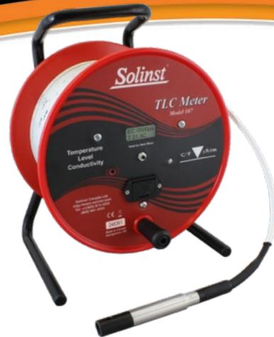
**La sonde TLC modèle 107** (température, niveau, conductivité) affiche des mesures précises de la conductivité et de la température sur un écran à cristaux liquides pratiques. Les niveaux d'eau sont lus sur le ruban plat Solinst gradué avec précision au laser lorsque le signal lumineux et l'avertisseur sonore sont déclenchés.
