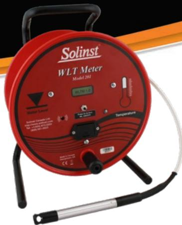
**La sonde de température et de niveau d'eau modèle 201 (WLT)** mesure avec précision le niveau statique, ainsi que la température de l'eau. Les niveaux d'eau sont lus sur un ruban plat en gradué tous les millimètres (ou tous les 1/100e de pied), disponible en longueurs jusqu'à 600 m (2 000 pieds). Les mesures de température sont affichées sur un écran à cristaux liquides de -20 à +125 °C, avec une précision de  $\pm 0,1$  °C entre -5 et +50 °C et  $\pm 0,5$  °C en dehors de cette plage.
