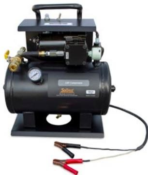
**Le compresseur 12 volts** est léger et compact, idéal pour une utilisation sur le terrain. Il utilise toute source d'alimentation en courant continu de 12 volts, comme la batterie d'une voiture ou d'un camion. Le compresseur fonctionne à 150 psi avec un réservoir d'air de 7,6 litres (2 gallons US) pouvant atteindre 175 psi.
