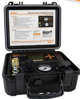
**L'unité électronique de contrôle des pompes 464** régule l'alimentation en gaz comprimé des pompes pneumatiques à vessie et des pompes à double valve. Elle utilise 4 piles AA et fournit 125 psi (unité 250 psi également disponible). Des options de mode d'échantillonnage pré-réglé entièrement automatiques et jusqu'à 99 débits uniques créés par l'utilisateur peuvent être enregistrés. Le contrôleur peut également être utilisé manuellement, et sans piles.
