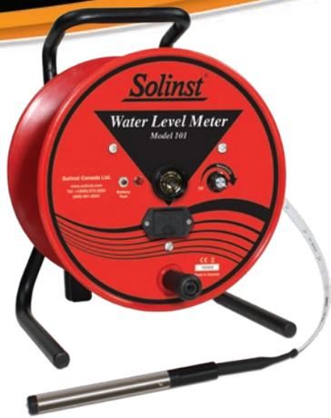
Les sondes de niveau d'eau modèle 101 sont très robustes et permettent d'effectuer des mesures du niveau d'eau dans des puits, des réservoirs et des trous de forage de manière facile et fiable. Le ruban plat est gradué de manière permanente tous les millimètres (ou tous les 1/100e de pied).
