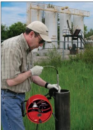
Si le liquide est une huile ou un hydrocarbure/produit non conducteur, les signaux sont constants. Si le liquide est conducteur (eau), la conductivité de l'eau ferme un circuit de conductivité. Cela neutralise le circuit infrarouge et les signaux sonore et lumineux sont activés de manière intermittente.
