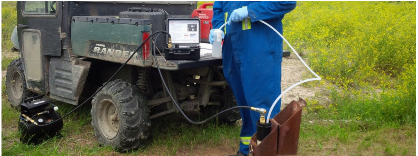
Échantillonnage des eaux souterraines avec une pompe à vessie dédiée utilisant un compresseur et un contrôleur portables, robustes et faciles à utiliser
