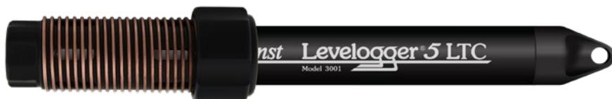
**Remarque :** Tous les Leveloggers doivent être déployés et stockés avec le capuchon d'installation ou le câble de lecture directe L5 attaché. Cela évite de vider inutilement la batterie et protège l'œil optique.
