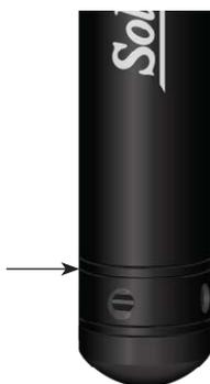
Figure 8-6 : Ligne de mesure de l'enregistreur
