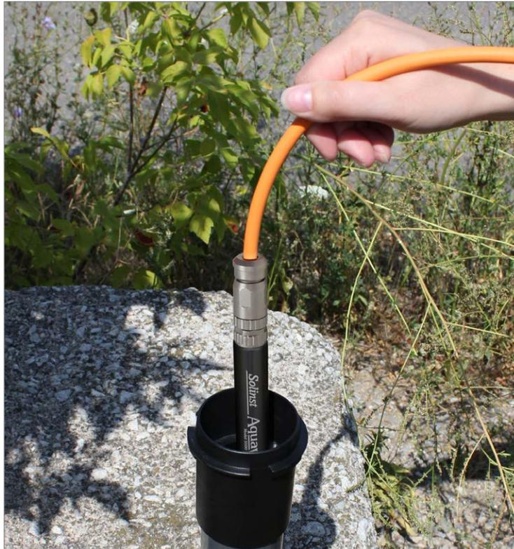
Raccordez l'autre extrémité du câble ventilé à l'enregistreur AquaVent 5. Reportez-vous à la section 1.5.1 pour plus de détails. Abaissez le câble ventilé muni de l'enregistreur dans le puits.
