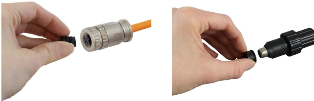
Enlevez les bouchons d'entreposage des connecteurs de la tête de puits Wellhead et du câble ventilé.
