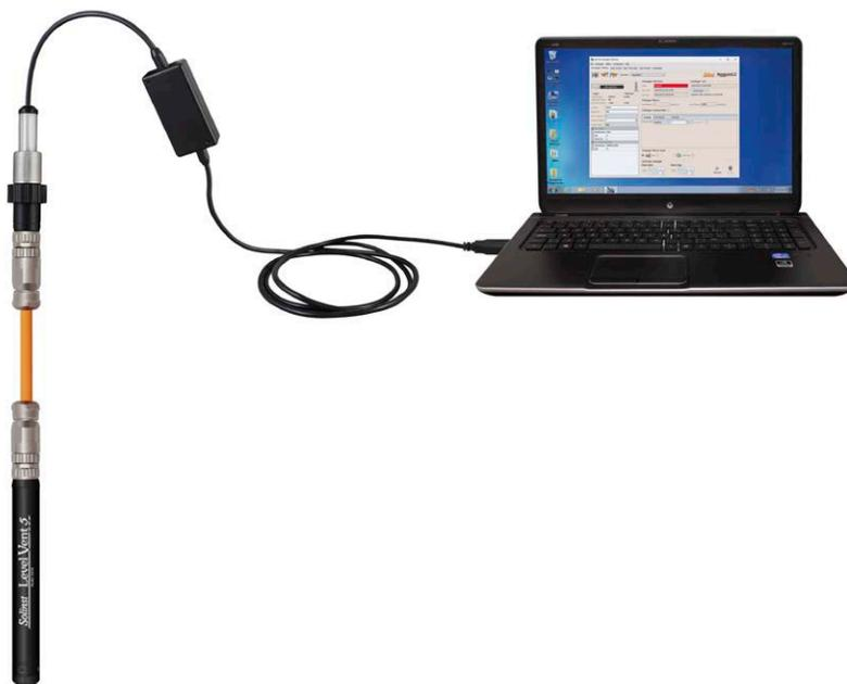
L'AquaVent communique avec un ordinateur portable ou de bureau à l'aide d'un câble de connexion USB connecté à la tête de puits AquaVent. Le câble de connexion USB se connecte à la connexion à 10 broches (protocole Solinst).
