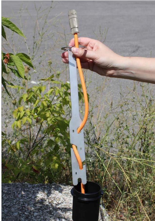
Enroulez l'extrémité supérieure du câble ventilé autour du support de suspension, puis insérez-le dans les encoches pour fixer le câble au support. Laissez environ 5 cm (2 po) de mou dans le câble au-dessus du support de suspension.
