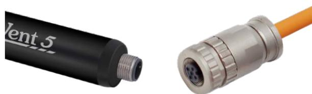
Alignez l'ergot de positionnement de l'enregistreur avec la cavité de positionnement du connecteur du câble ventilé. Poussez doucement la tête de puits Wellhead et le câble ventilé ensemble et tournez-les légèrement jusqu'à ce que vous perceviez un **petit déclic** lorsque le raccordement correct se fait.
