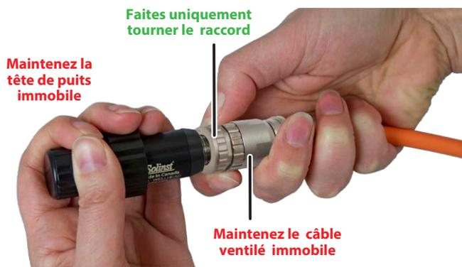
**Serrez le raccord en acier inoxydable jusqu'à ce qu'il soit bien en place** tout en maintenant le câble ventilé et la tête de puits immobiles. Serrez le raccord jusqu'à ce qu'il soit bien en place. **Veillez à ne pas tordre le câble ventilé ou la Wellhead.**
