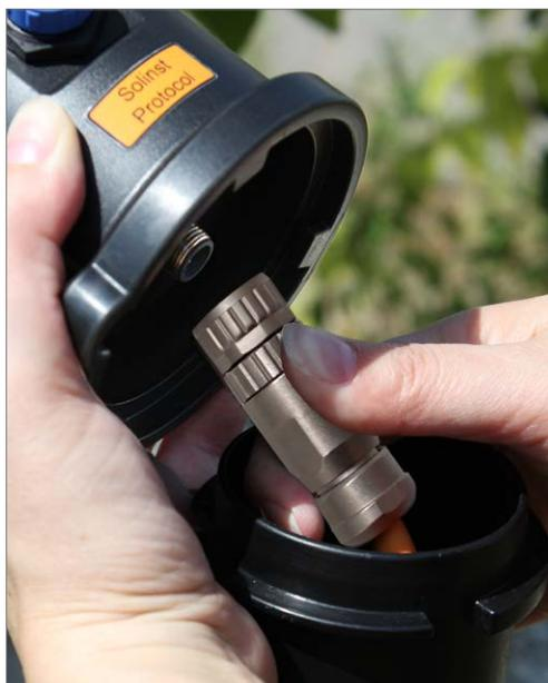
Raccordez le câble ventilé à la tête de puits Wellhead. Reportez-vous à la section 1.5.1 pour plus de détails. **Effectuez une mesure manuelle de la profondeur jusqu'au niveau de l'eau pour vos dossiers.**
