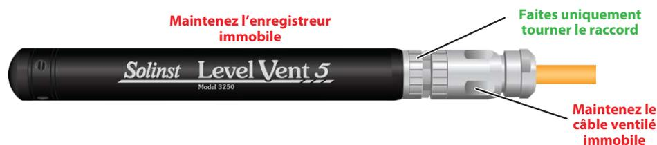
Serrez le raccord en acier inoxydable jusqu'à ce qu'il soit bien en place tout en maintenant le câble ventilé et l'enregistreur immobiles. Serrez le raccord en acier inoxydable jusqu'à ce qu'il soit bien en place. **Veillez à ne pas tordre le câble ventilé ou l'enregistreur.**
