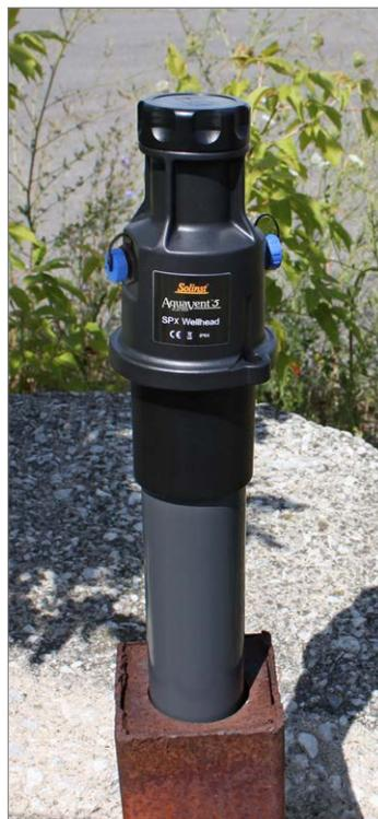
Poussez avec précaution l'excédent de câble ventilé dans le puits. Vissez la tête de puits Wellhead sur la base du couvercle du puits jusqu'à ce qu'elle repose bien sur l'épaulement.
