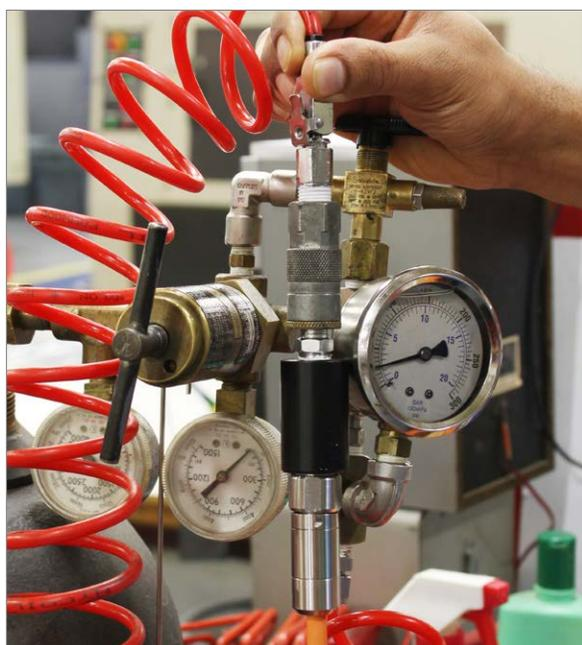
Figure 9-6 : Azote soufflé à travers le câble ventilé
