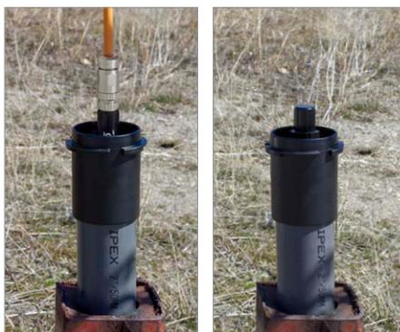
Retirez l'un des bouchons rouges de l'insert. Abaissez l'enregistreur LevelVent 5 et le câble ventilé par l'ouverture puis dans le puits, jusqu'à ce que la tête de puis repose sur l'insert. Retirez l'autre bouchon rouge de l'insert et effectuez une mesure manuelle de la profondeur jusqu'au niveau de l'eau pour vos dossiers.
