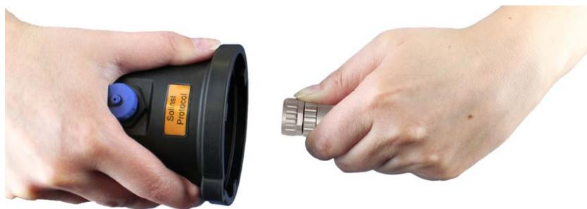
Poussez doucement la tête de puits Wellhead et le câble ventilé ensemble. Tournez le connecteur du câble légèrement jusqu'à ce que vous perceviez un petit déclic lorsque le raccordement correct se fait.
