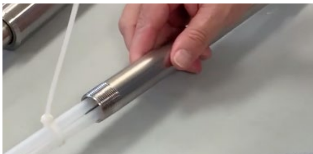
Poussez/déplacez l'attache-câbles le long de la tubulure pour la regrouper et éviter qu'elle ne se torde.
