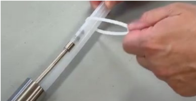
Utilisez des attaches de câble pour regrouper la tubulure.
