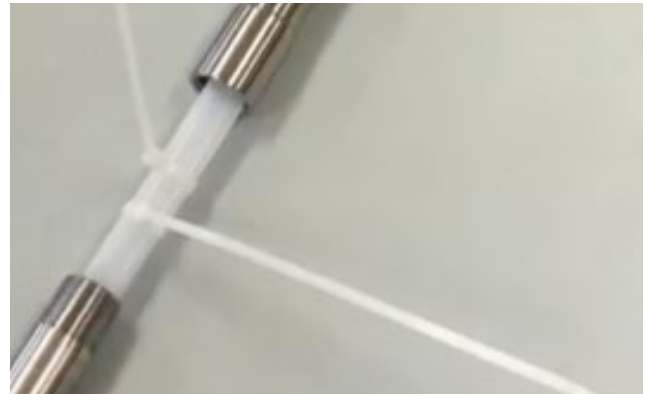
Coupez et retirez les serre-câbles. Maintenant, faites glisser lentement l'extension en place et serrez-la.
